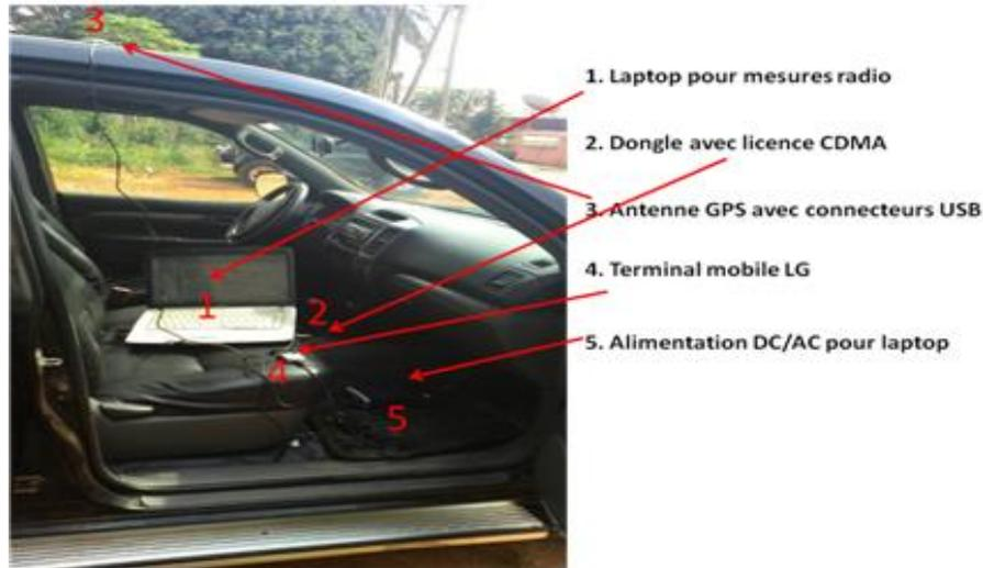
Figure 1 : Kit de mesure et de collecte installé sur véhicule.
